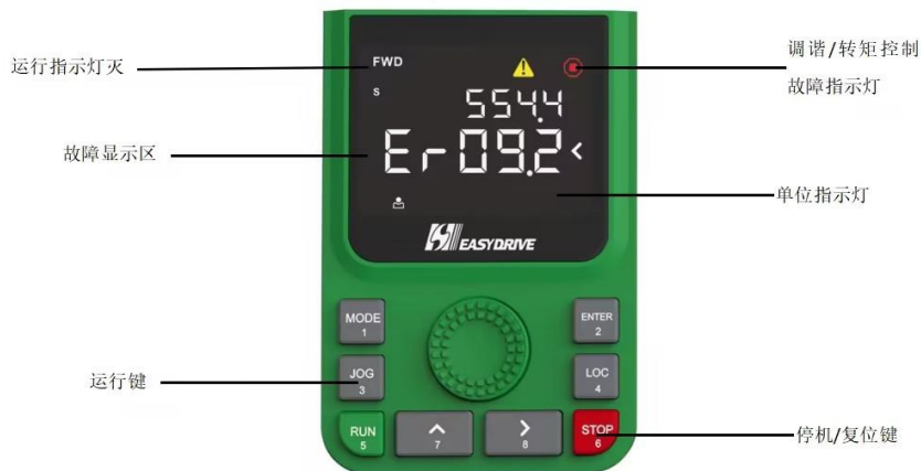
图 11-1 板载键盘界面故障显示
