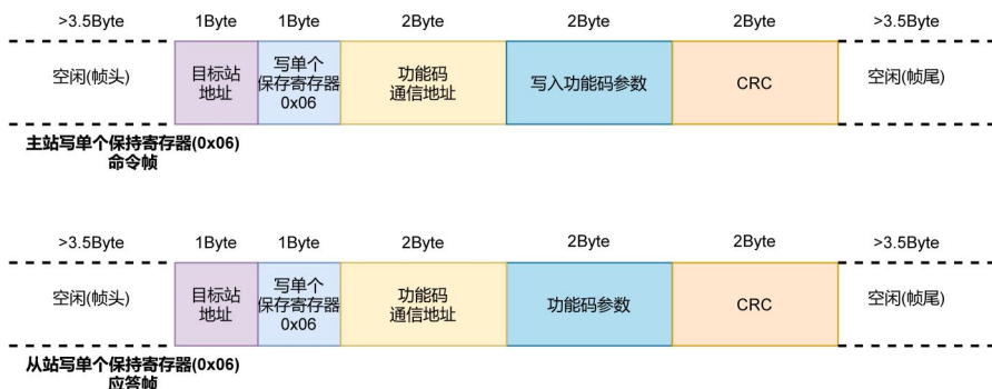
图 14-7 RS485 通信数据帧结构 2
