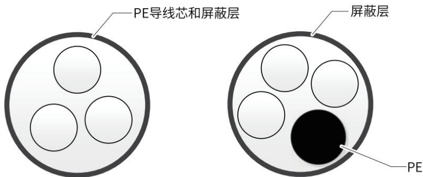
图 4-1 推荐的动力线缆类型
