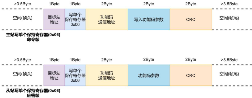
图 9-31 RS485 通信数据帧结构 2
