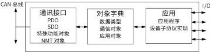
图 9-46 CANOpen 通信模型示意图
