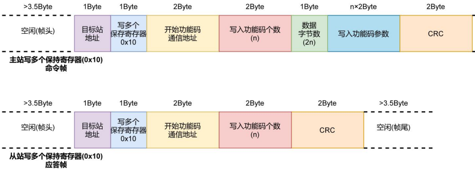
图 9-32 RS485 通信数据帧结构 3
