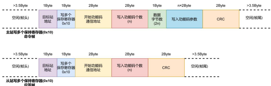
图 9-32 RS485 通信数据帧结构 3
